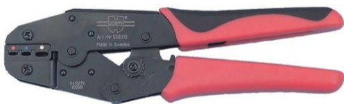
Pihdit eristettyä kaapelikenkää varten, 1,5–6,0 mm
